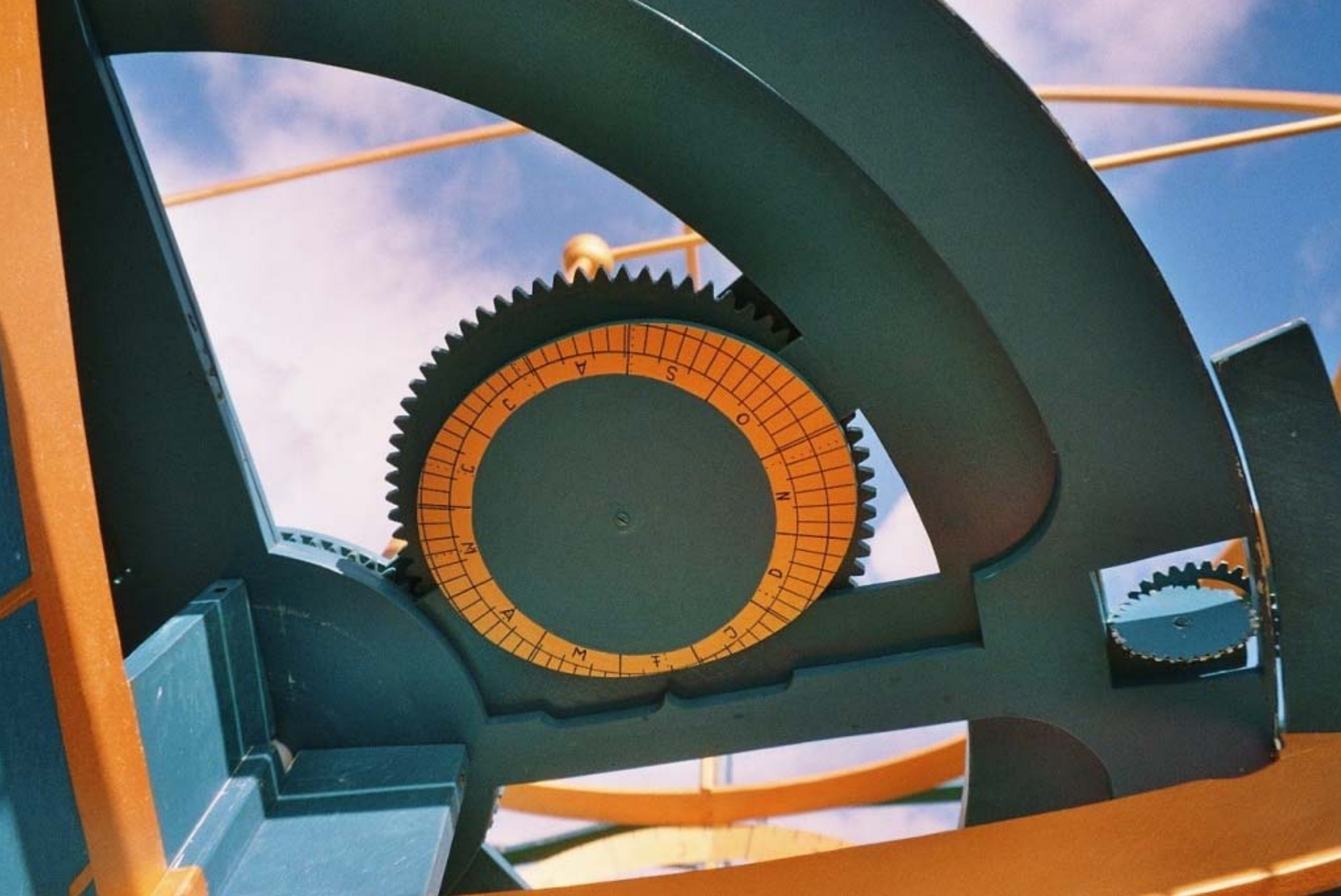
Die Unterseite des Uhrwerks mit Analemma-Stellscheibe und Getriebebezahnradern
